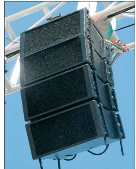
Front-Fill, compuesto de 4 Line Array AR-208, volado del truss delantero a través de un polipasto manual. Para cubrir los primeros metros del escenario hasta al punto de encuentro de la dispersión horizontal del sistema de P.A., logrando muy buen resultado en esta zona muy concurrida y habitualmente poco cubierta, siendo ya utilizado, en otras producciones, sistemas de características similares en formato Line Array como Front-Fill por las ventajas que ofrece en la calidad de cobertura y tímbrica, ya que forma parte de la misma familia de Line Array que los utilizados en la P.A.
